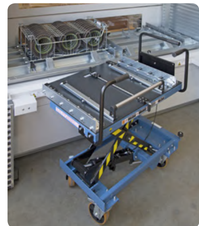
Lifttablar mit Übergabestation und Transportwagen für Schleifscheiben
