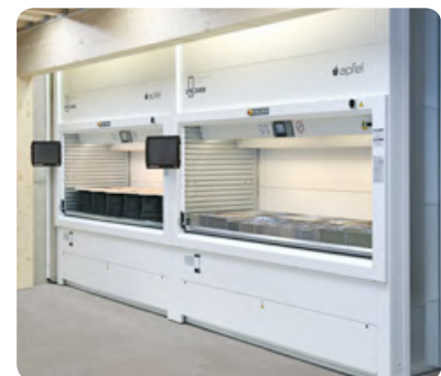
Tandem-Lagerturm in ESD-Ausführung mit Ausgaben in zwei Stockwerken
